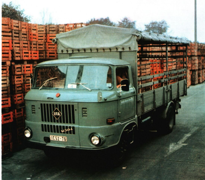
Abb. 3, 4 und 5: Ebenso vielseitig verwendbar ist das Speditionspritschenfahrzeug W 50 L/Sp; hier eingesetzt als Auslieferungsfahrzeug der Getränkeindustrie und beim Handelstransport im Haus-zu-Haus-Verkehr.
